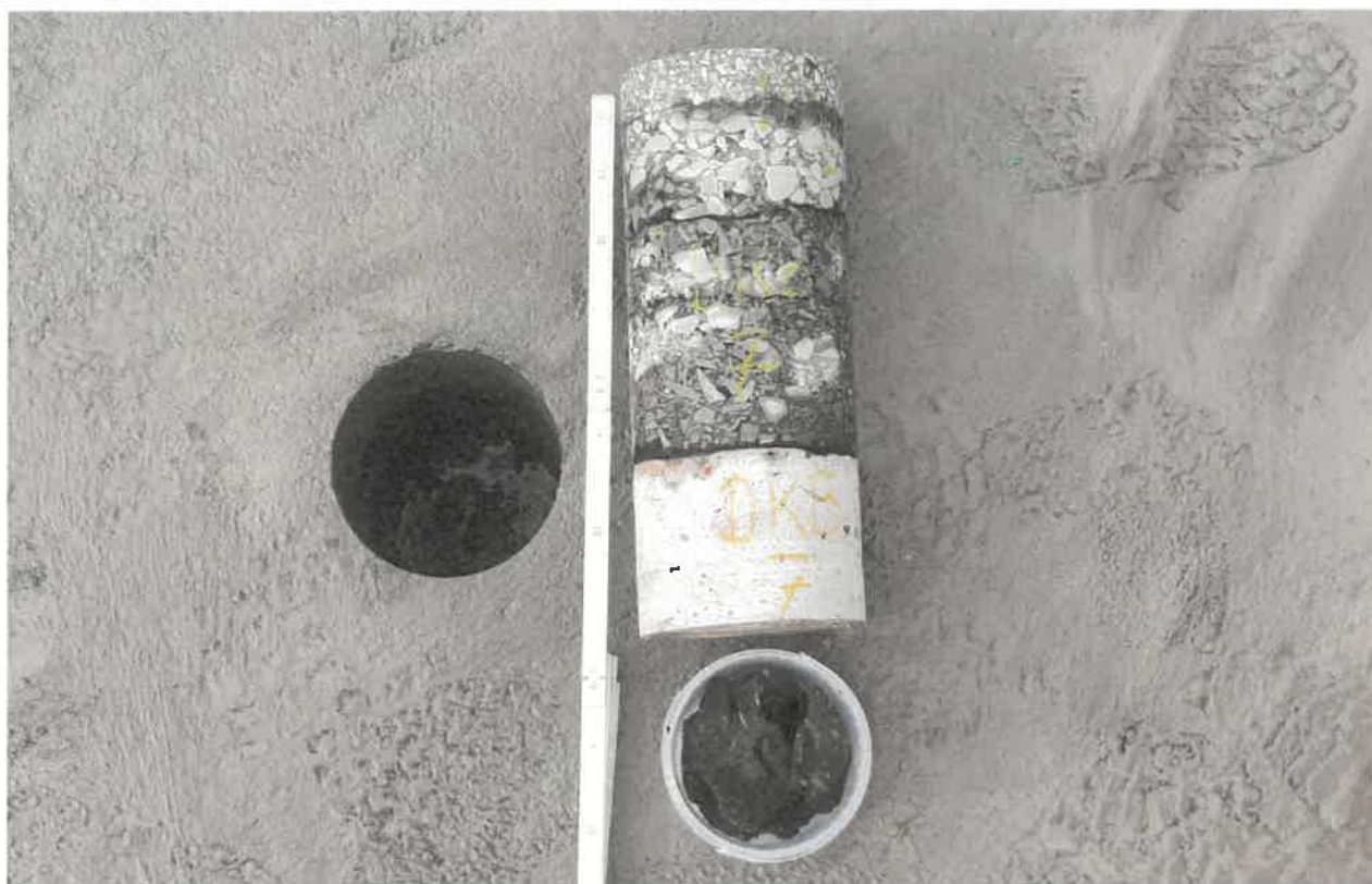
Abb. 7: BW 32-1 DKB 7 mit Dichtung
