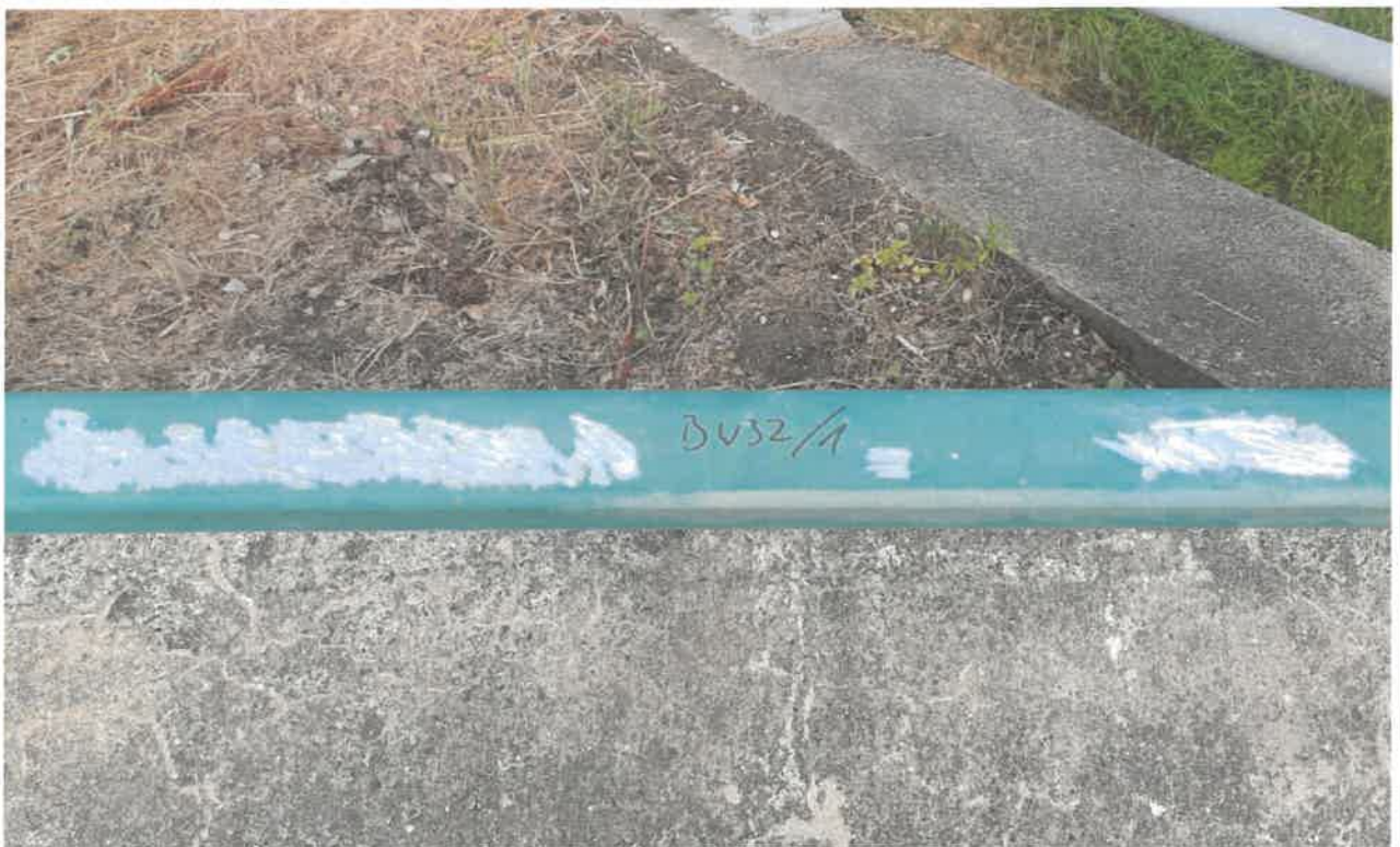
Abb. 3: BW 32-1 Probenahme Korrosionsschutz Geländer
